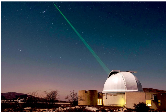
Meo télescope (SLR) de 1.5m de diamètre, réalise des mesures de distance Terre-Lune [ENSG]
