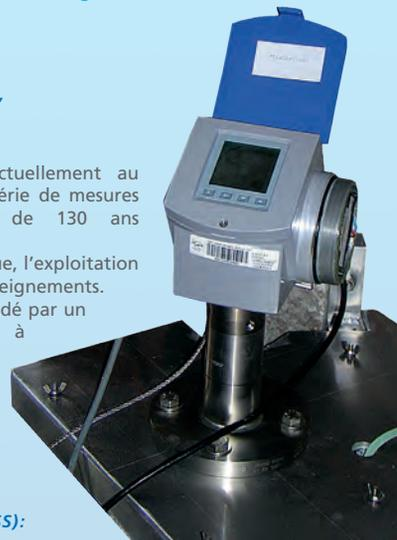
Capteur radar du marégraphe numérique
