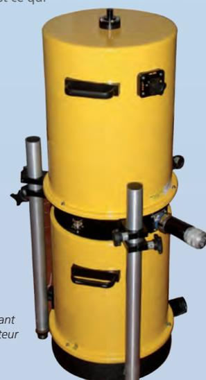
Gravimètre absolu, mesurant l'intensité de la pesanteur
