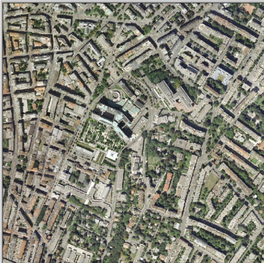
La résolution de l'image est de 10cm, ce qui permettra de pointer des détails au pixel près (un pointé subpixelaire aurait été préférable, mais n'a pas pu être réalisé ici).
